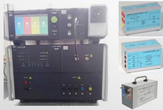
2.4 DIP Voltage Dips 电压暂降 Short interruption 短时中断 Voltage variation 电压变化
